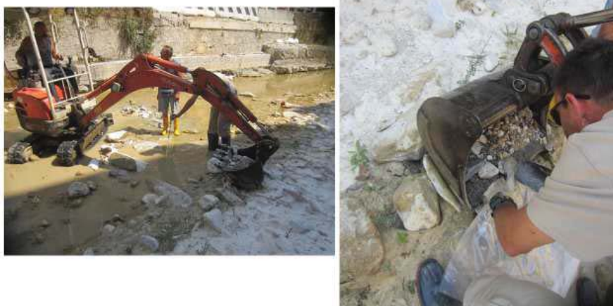
Figura 1.4: La tecnica di prelievo di un campione di sottostrato consisteva nell'asportazione preliminare, a mezzo di scavatore in alveo, dello strato superficiale di sedimenti per uno spessore intorno ai 50 cm, seguita dal prelievo di un volume significativo di sottostrato
