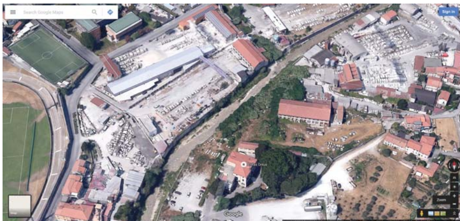
Figura 1.27: Curva localizzata a monte di Via Piave. In sponda destra il muro a difesa del piazzale utilizzato dalla ditta Italaconvoy ha subito collassi recenti e richiederà specifica attenzione.
