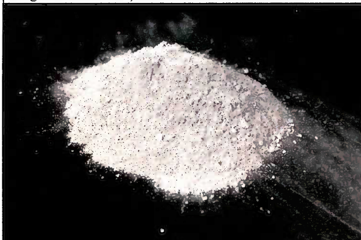
Figura 46 - Fango di granito essiccato e frantumato (foto eseguita da D. Basilio).
