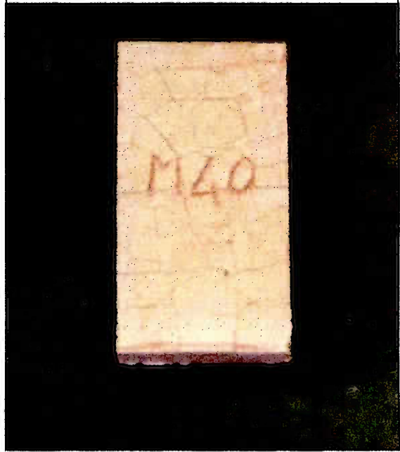
Figura 50 - Provino confezionato con forme da 1×5×10 cm, fessuratosi dopo la cottura (foto eseguita da D. Basilio).
