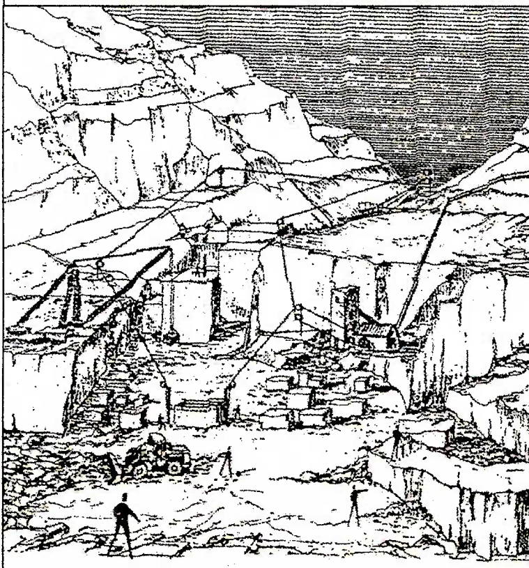
Figura 2 - Rappresentazione di cava con impianto a filo elicoidale (dall'articolo di G. Canavesio in Marmomacchine Directory 1990-91).
