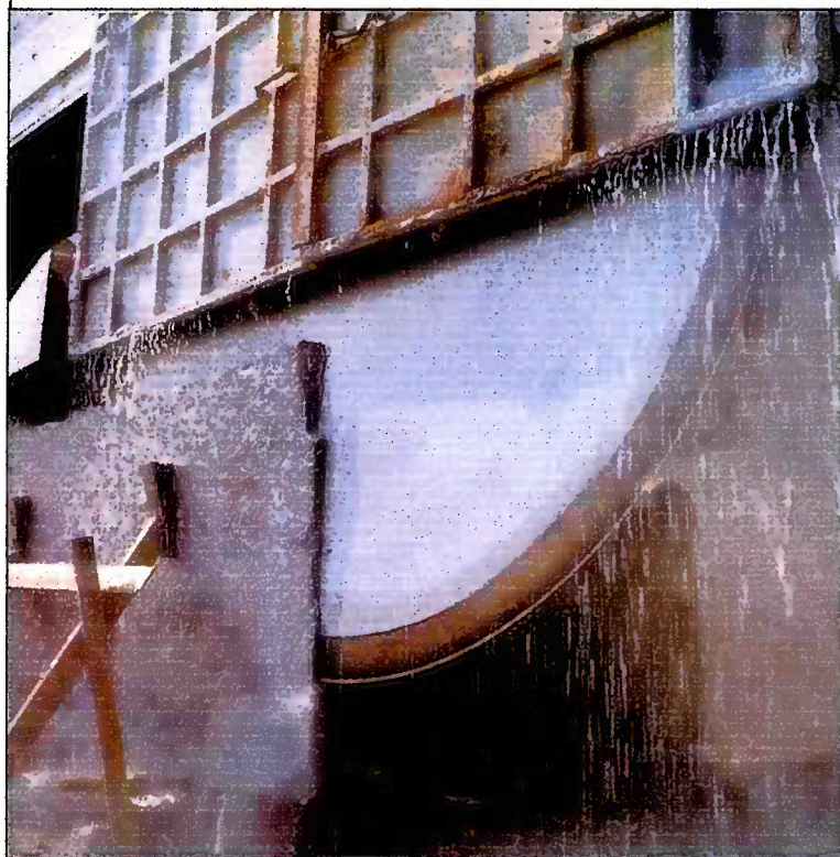
Figura 15 - Segatrice a disco gigante (da Marmomacchine Directory 1997-98: DELLAS SpA).
