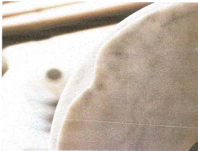
Figura 2.3: difetto causato da un brusco inizio del contatto perlina-disco in fase di taglio
