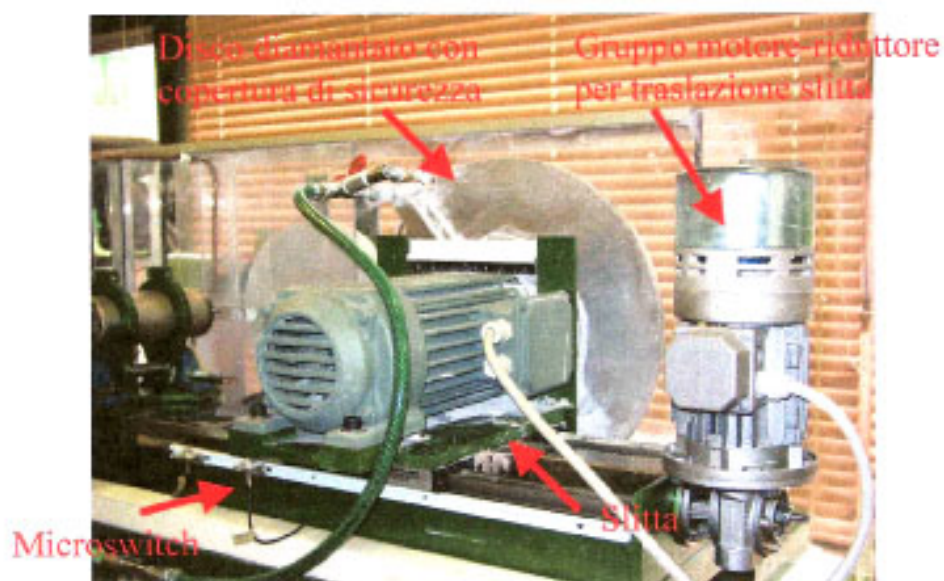
Figura 1.12: sistema di creazione "solchi di scarico"
