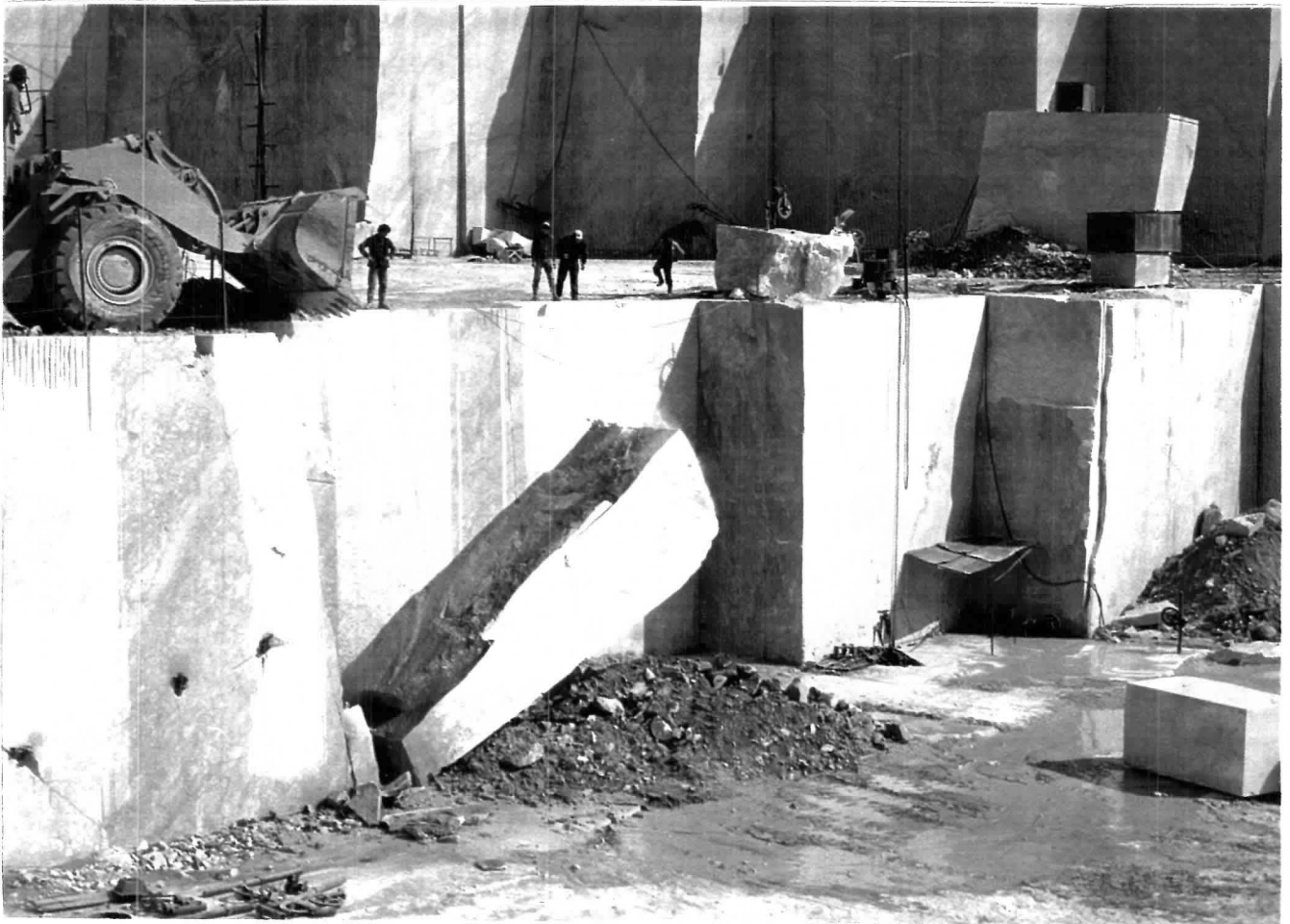
FIGURA 21 RIBALTAMENTO DELLA BANCATA PER SPINTA CON PALA MECCANICA
