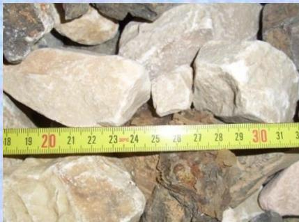
Per la struttura in elevazione (e la sua base) sono state usate pietre di vario materiale a seconda delle necessità dell'esperimento: la foto accanto ne mostra appunto la forma e la dimensione; si è cercato di scegliere pietre con spigoli levigati e forma più possibile regolare.
