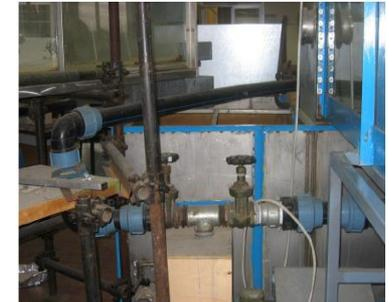
Ciascuna prova prevedeva la partenza da condizioni standard, verificate a secco. In seguito, utilizzando un idrometro, si andava a valutare in intervalli di tempo consoni la variazione della morfologia dello scavo fino a che questo non raggiungesse una configurazione stabile di equilibrio (generalmente dai 120 ai 300 minuti).
