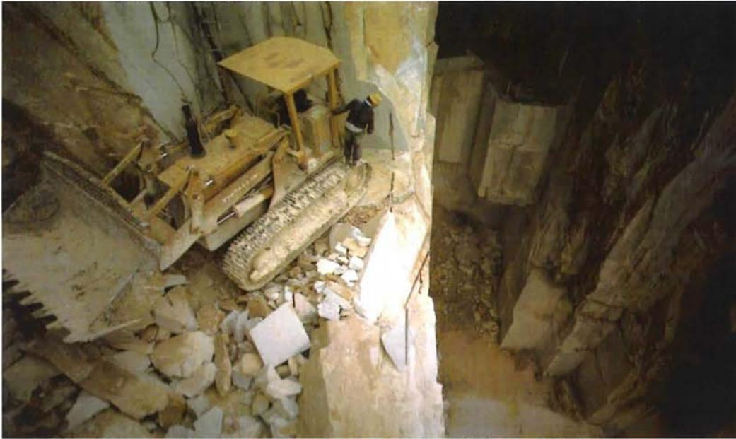
Foto 9. Posizionamento critico di pala meccanica cingolata per movimentazione detriti in parete
