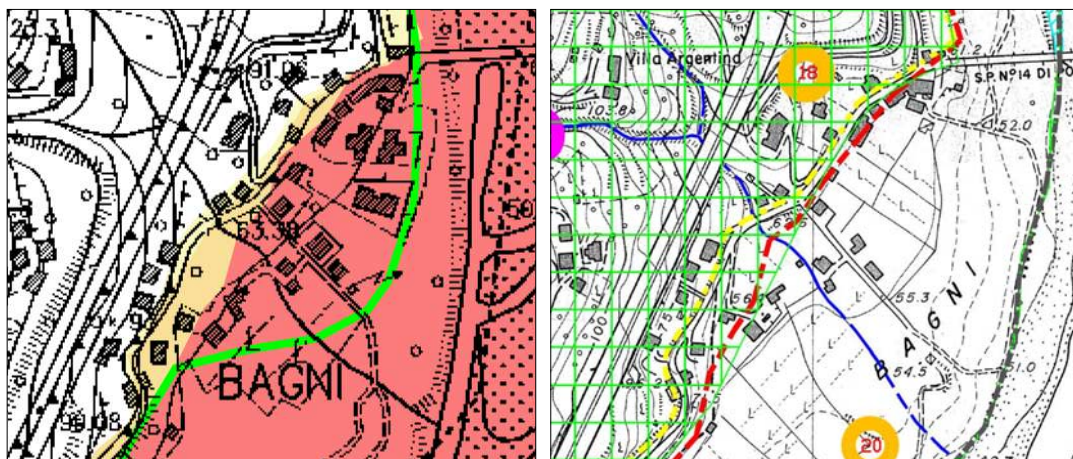
Figura 5.25 - 5.26 - Confronto nella località Bagni di Podenzana, a sinistra la carta della pericolosità idraulica del P.A.I., a destra la Tav.2 Idrologia del P.S. di Podenzana (le linee tratteggiate a diversa colorazione indicano le due aree a diversa pericolosità).
