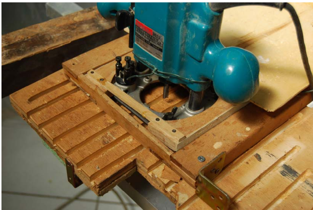
Figura 75 – Duomo di Carrara, Croce lignea sec XIV, restauro del 2006-2008 del laboratorio Lo Studiolo di Lucca, rimozione del pannello in compensato marino dal retro del supporto originale. Foto del 2006 del laboratorio di restauro Lo Studiolo di Lucca.
