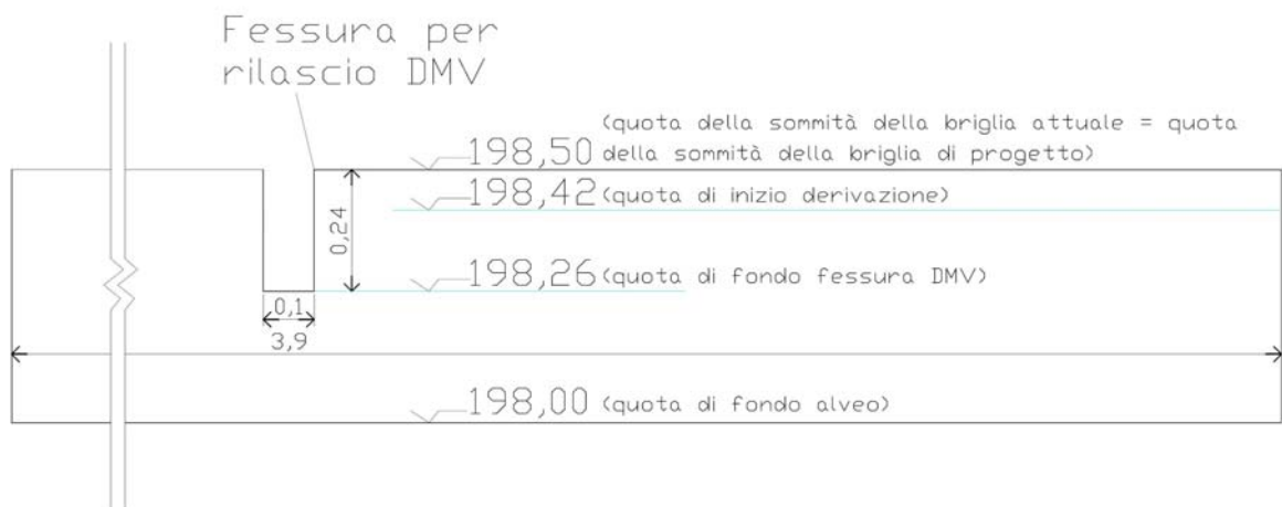
Figura 4.2.3 – Veduta d'insieme della presa – situazione di progetto
