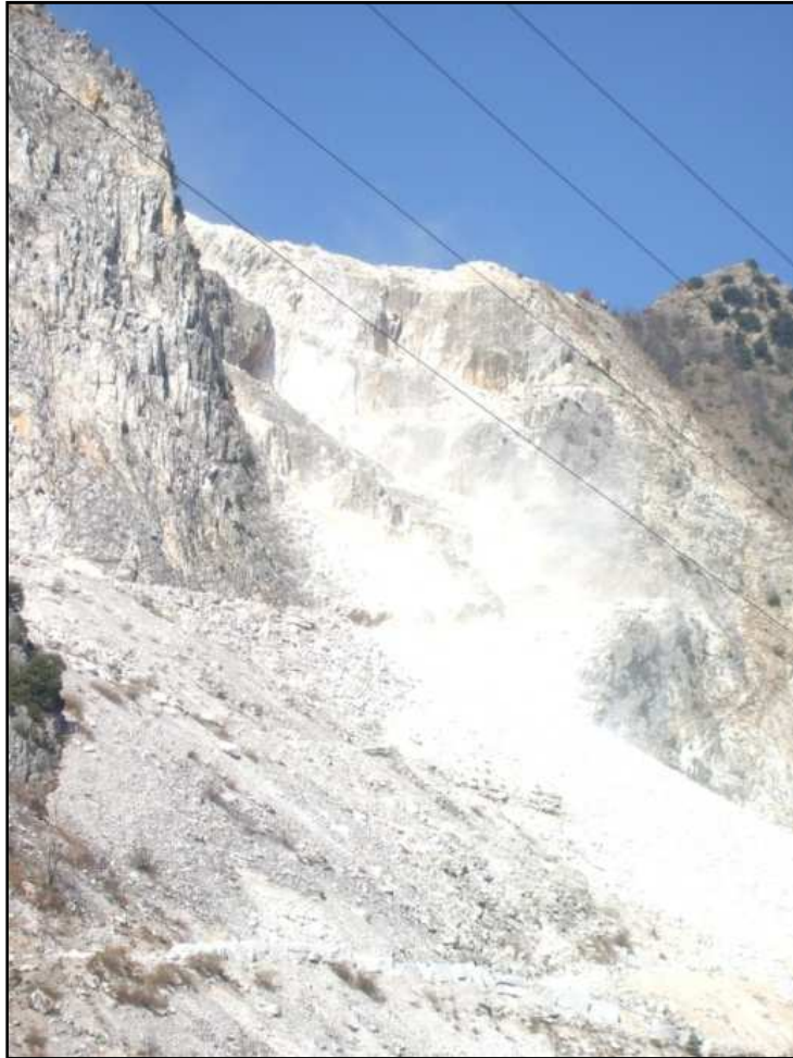
Figura 35: Ravaneto Canal Piccino, ripresa dell'istante in cui la cava culminale scarica i detriti. 3/03/09
