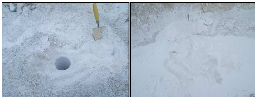
Figura 40: Cutting di una macchina perforatrice Figura 41: Cutting prodotto dal filo diamantato.
