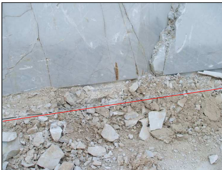
Figura 31: Filo diamantato messo in opera durante un taglio al monte
