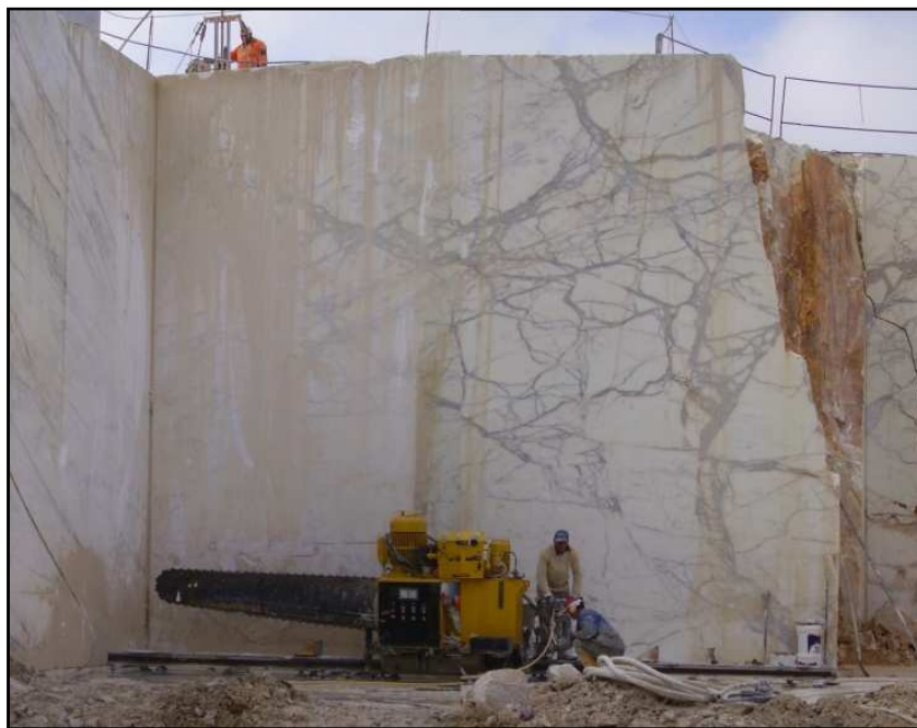
Figura 32: Messa in opera di una tagliatrice a catena, per l'esecuzione di un taglio alla base della bancata.
