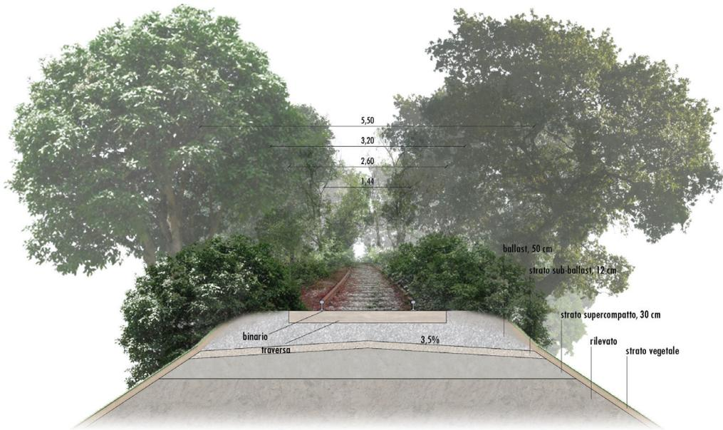
Fig. 4.38: Sezione dello stato di fatto del tracciato
