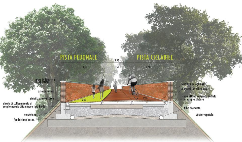
Fig. 4.39: Sezione dello stato di progetto del tracciato
