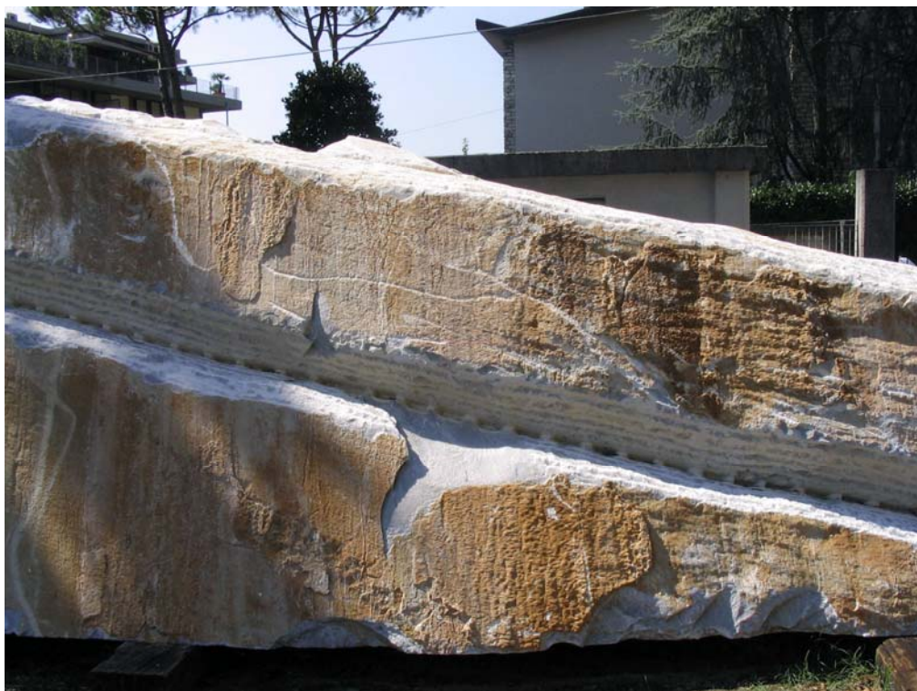
Figura 9 Grande trincea trovata nelle cave lunensi in stato di abbandono del lavoro estrattivo, con serie di alloggiamenti per cuneo, e parti di cuneo ferreo infisse nella roccia, Museo del Marmo in Carrara (foto dell'autore)
