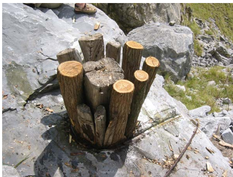
Figura 20 Foro nella roccia riempito con piro ligneo e zeppe a Resceto -MS (foto dell'autore)
