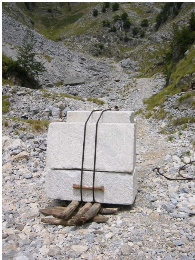
Figura 22 'carica' di manufatti marmorei su via di lizza: in basso sono visibili i parati che vengono progressivamente appoggiati a terra per lo scorrimento del peso soprastante, rievocazione storica a Resceto -MS (foto dell'autore)
