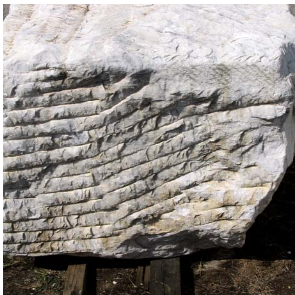
Figura 8 Tracce di subula ad andamento parallelo regolare, Museo del Marmo in Carrara, (foto dell'autore)
