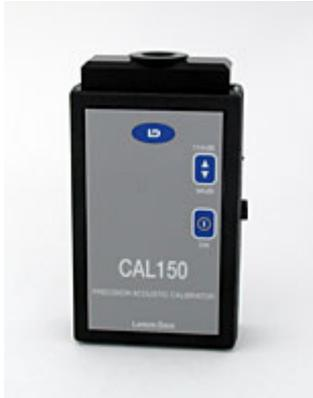
Prima di iniziare ogni misura si è proceduto alla regolazione della sensibilità interna del fonometro attraverso un calibratore acustico, il quale è un dispositivo che produce un livello di pressione sonora di riferimento al diaframma del microfono una volta che è inserito nel calibratore stesso. La calibratura è stata effettuata a 114 dB.
